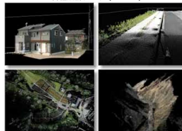
当社が、リーグルLMS-Z420iを導入したのは平成17年11月のことです (県内でこの機器を保有しているのは弊社のみ、全国でも十数台?)。測定精度±1cm・測定スピード8000~11000点/秒・測定距離600~800mの点データ (XYZ) を360°全周を一挙に取得することができます。
